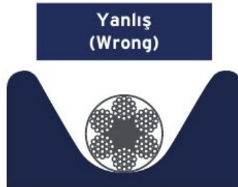
Yiv Çok Geniş Sheave Groove Too Wide
