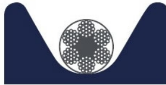
Yiv Çok Geniş Sheave Groove Too Wide
