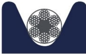
Yiv Çok Dar Sheave Groove Too Narrow
