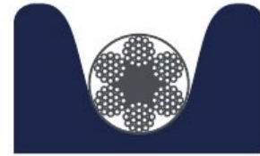
Yiv Halatın Çevresinin %33'ünü Sarmalı Sheave Groove Correctly Supporting The Rope For 33% Of It's Circumference
